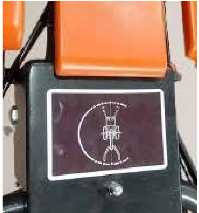
Abbildung 11 – Aufkleber zum horizontalen Verschieben der Lenker horizontal
