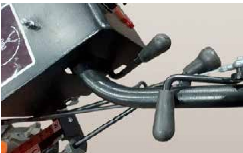
Figure 10 - Levier de déplacement du guidon horizontalement
