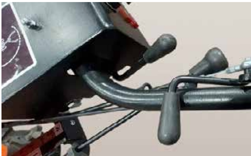
Bild 12 – Hebel zum vertikalen Bewegen des Lenkers
