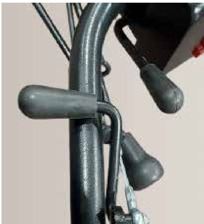
Figura 10 - Leva per lo spostamento del manubrio orizzontalmente
