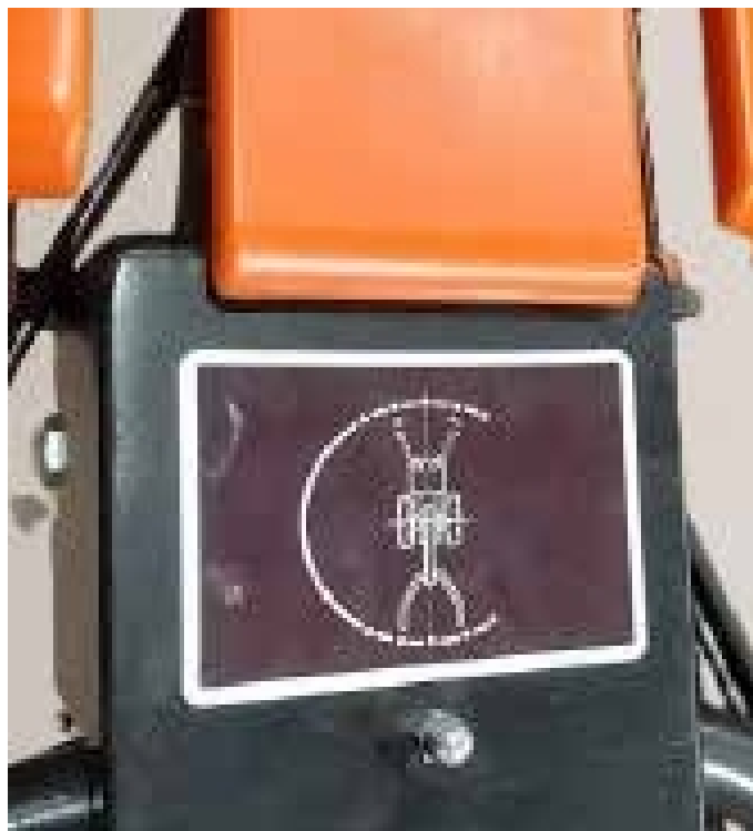
Photo 11 - Stiker pour déplacer le guidon horizontalement
