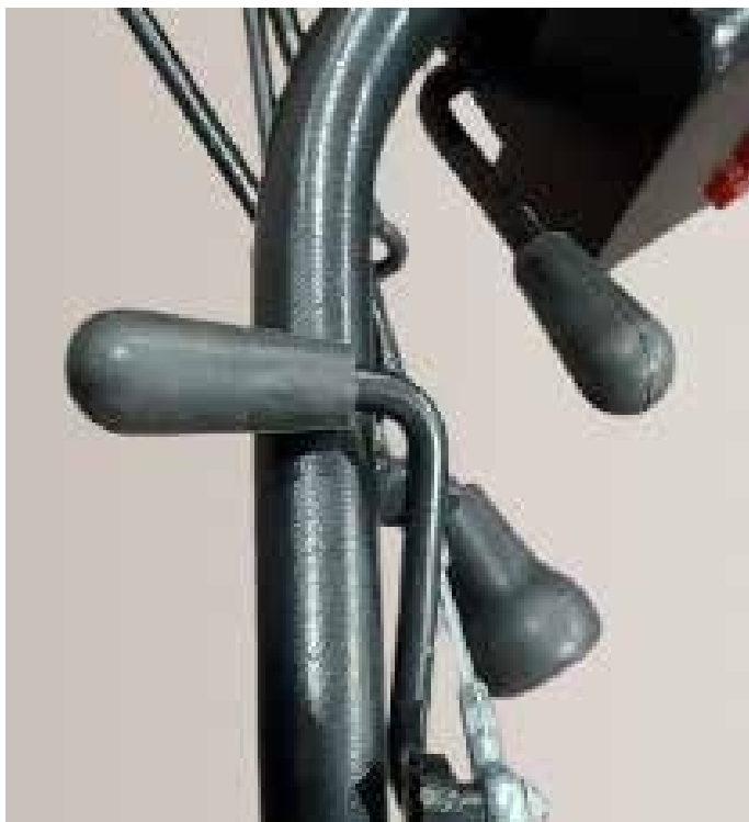
Figure 10 - Levier de déplacement du guidon horizontalement
