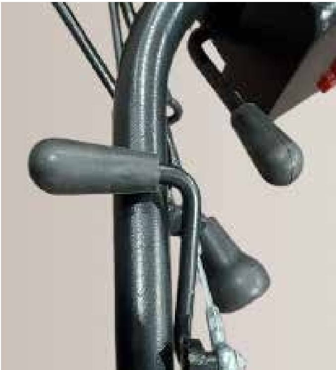
Abbildung 10 – Hebel zum Bewegen der Lenker horizontal
