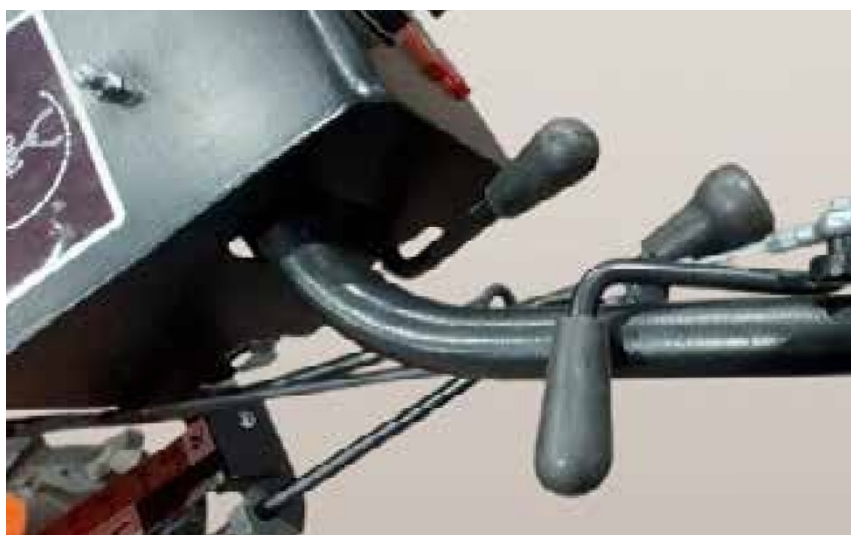
Figura 10 - Leva per lo spostamento del manubrio orizzontalmente
